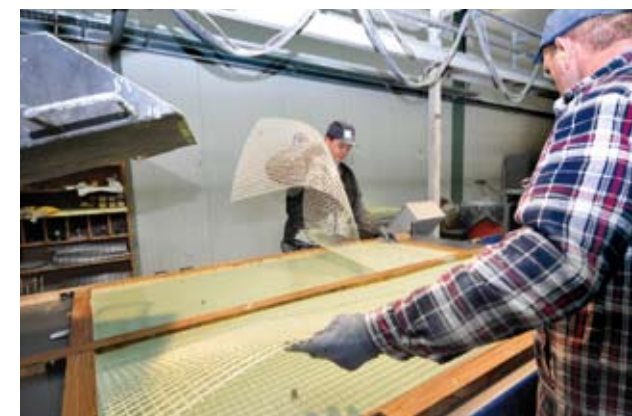
Herstellung von textilbewehrten Fassadenelementen
