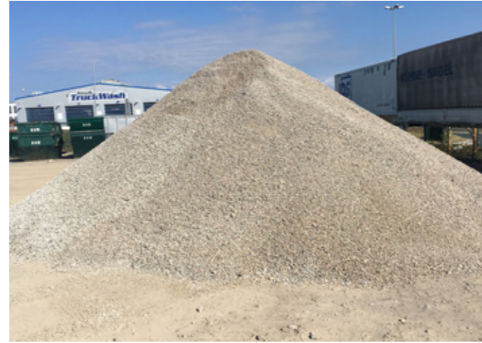
Herstellung recycelter Gesteinskörnungen (HERING Bau)
