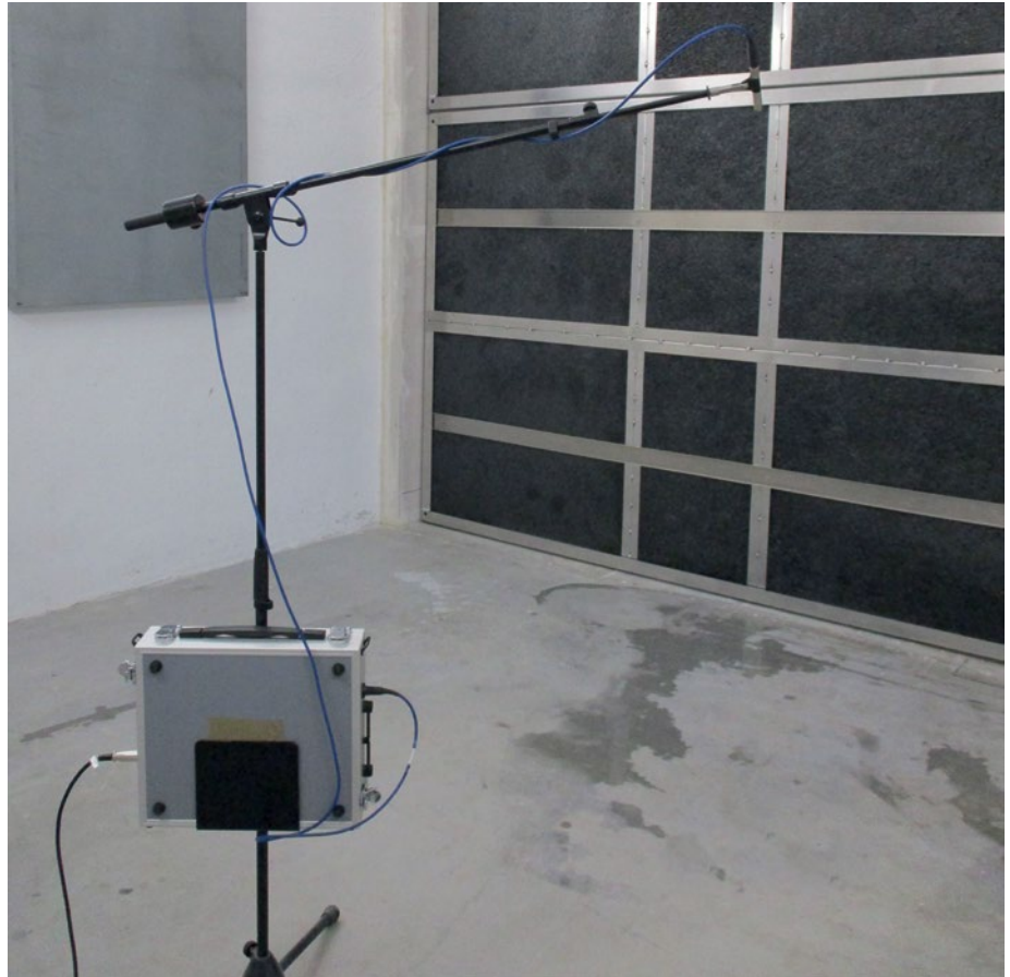
Abb. 3: Durch Messungen im Labor konnten sehr gute Absorptionswerte nachgewiesen werden.
