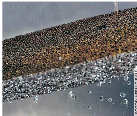
Der Drainageboden verhindert bei der High-Pressure-Fußbodenreinigung stehendes Restwasser und ist sofort trocken.
